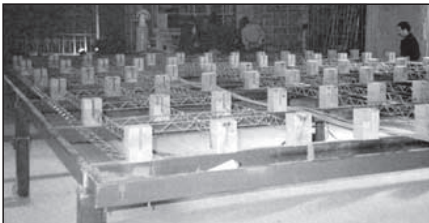
Mal voor het assembleren van grote Poutrafil® kaders
